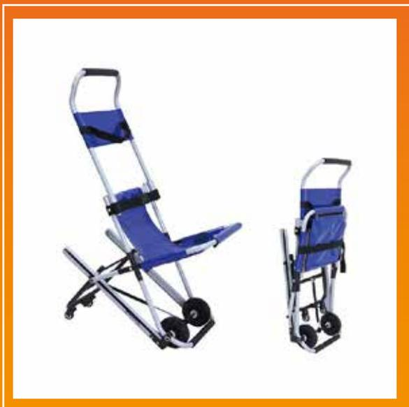
La sedia manuale per evacuazione è un dispositivo destinato all'evacuazione di emergenza in posizione seduta e rivolto al trasporto di persone anziane, disabili e in generale di persone con ridotta o impedita capacità motoria, temporanea o permanente. L'utilizzo delle bande di gomma, che scorrono sulle scale, garantisce un alto livello di sicurezza e riduce al minimo lo sforzo fisico necessario. Consente la sicura ed efficace evacuazione delle persone durante le procedure di discesa.
